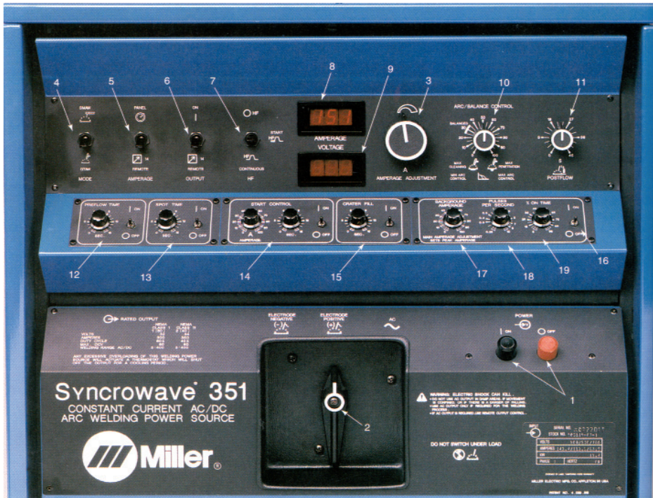
Мал. 7.6. Панель пульта керування установки для зварювання вольфрамовим електродом марки Syncrowave*351 фірми Miller Electric (США)
