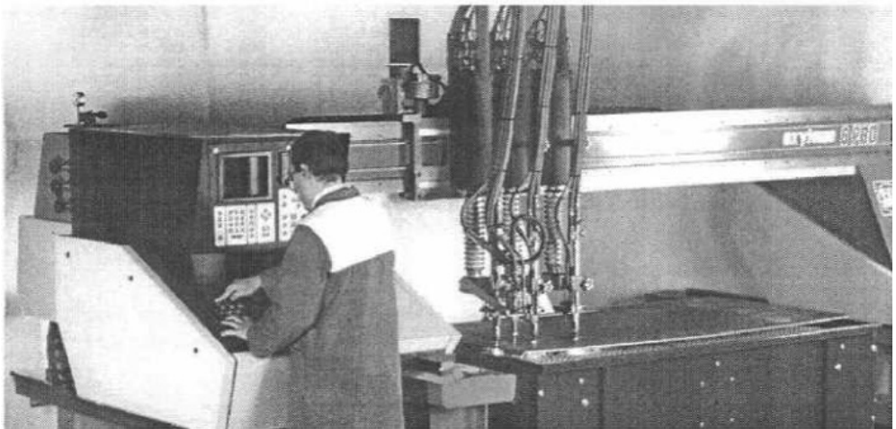
Мал. 15.11. Стационарна машина для газокисневого різання з програмним керуванням марки ОХУТОМЕ фірми «AIR-LIQUIDE Group»
